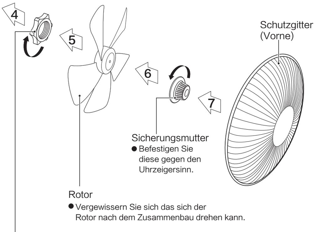
Sicherungsmutter auf das hintere Schutzgitter schrauben
