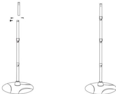
7. Befestigen Sie den Heizkopf mit 2 Schrauben 4 x 12 mm am obersten Rohr.
