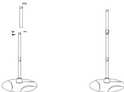
6. Gehen Sie wie in Schritt 3 vor, um das oberste Rohr zu befestigen, und bringen Sie den dritten Kabelhalter am obersten Rohr an.
