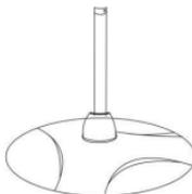
4. Befestigen Sie das untere Rohr und das zweite Rohr mit 3 Schrauben 5 x 6 mm und bringen Sie den ersten Kabelhalter am zweiten Rohr an
