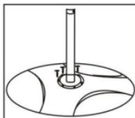
3. Stecken Sie die Zierverkleidung auf das untere Rohr.
