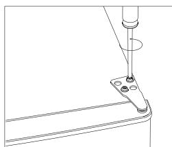
4. Schrauben Sie die Untere Aufhängung der Gefrierfach-Tür ab, entfernen Sie die Tür und stellen Sie sie auf einen weichen Untergrund.
