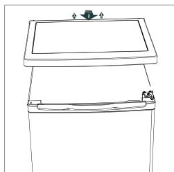
3. Schrauben Sie das obere Scharnier ab und entfernen Sie dann die Tür. Legen Sie die Tür auf eine weiche Unterlage, um Kratzer zu vermeiden.
