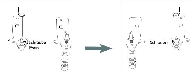
10. Montieren Sie den Halter, an dem der Stift für das untere Scharnier befestigt ist.. Ersetzen Sie den Nivellierfuß.
