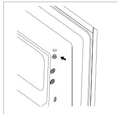
7. Drehen Sie die Gefrierfach-Tür um und befestigen Sie die Aufhängung.
