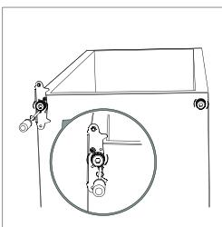
11. Montieren Sie jetzt die Tür. Vergewissern Sie sich vor dem Festziehen des oberen Scharniers, dass die Tür horizontal und vertikal so ausgerichtet ist, dass die Dichtungen an allen Seiten gut verschlossen sind.
