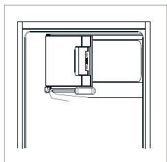
8. Schrauben Sie das untere Scharnier ab. Entfernen Sie dann den Nivellierfuß von der gegenüberliegenden Seite.
