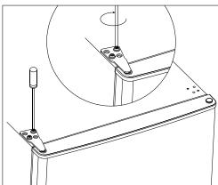
12. Bringen Sie die obere Abdeckung an und sichern Sie diese mit den 4 Schrauben an der Rückseite.
