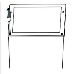
13. Entfernen Sie die Türdichtung des Gefrierschranks. Drehen Sie die Dichtung um 180° und bringen Sie sie wieder an.
