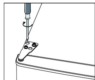
10. Setzen Sie die Scharnier- und Schraubenabdeckung zurück.
