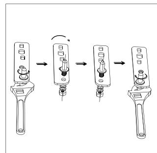
6. Befestigen Sie die Halterung, indem Sie den Stift des unteren Scharniers installieren. Installieren Sie die beiden Nivellierfüße.
