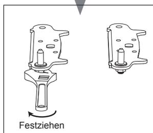
6. Montieren Sie den Halter, an dem der Stift für das untere Scharnier befestigt ist.. Montieren Sie die beiden einstellbaren Füße wieder.
