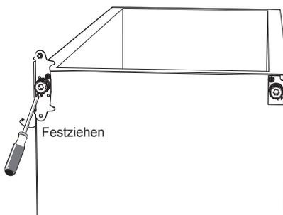
7. Montieren Sie jetzt die Tür. Vergewissern Sie sich vor dem endgültigen Festziehen des oberen Scharniers, dass durch die horizontale und vertikale Ausrichtung der Tür die Dichtungen an allen Seiten vollständig dicht anliegen.
