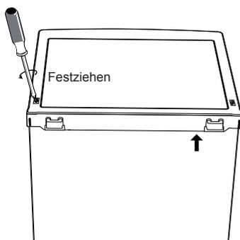
11. Vergewissern Sie sich bei geschlossener Tür vor dem endgültigen Festziehen des oberen Scharniers, dass die Tür horizontal und vertikal ordnungsgemäß ausgerichtet ist und die Dichtungen an allen Seiten vollständig dicht anliegen. Stellen Sie bei Bedarf die Nivellierfüße ein.
