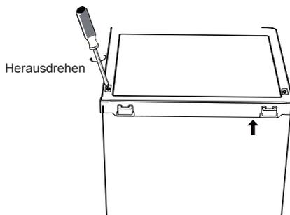
2. Heben Sie vorsichtig die obere Abdeckung 5 cm an und ziehen Sie den Anschlussstecker ab. Nehmen Sie danach das Oberteil ab.
