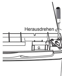
4. Entfernen Sie die Schrauben und das untere Scharnier. Entfernen Sie dann die verstellbaren Füße an beiden Seiten.
