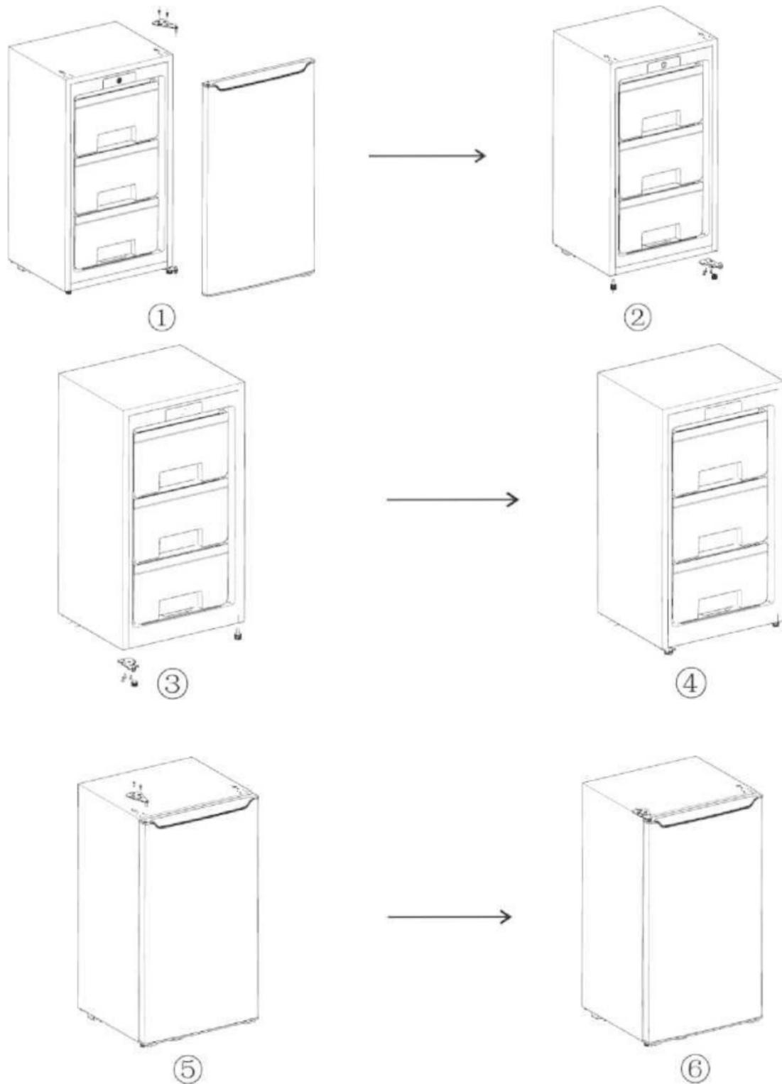
1. Entfernen Sie die beiden Schrauben, mit denen das obere Scharnier befestigt ist. Nehmen Sie das obere Scharnier ab. Bauen Sie die Tür ab und legen Sie sie vorsichtig beiseite.
