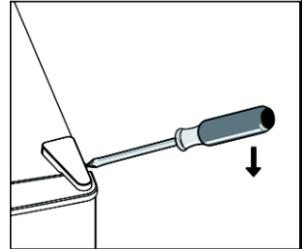
2. Lösen Sie die Schrauben. Dann entfernen Sie die Scharnierhalterung.
