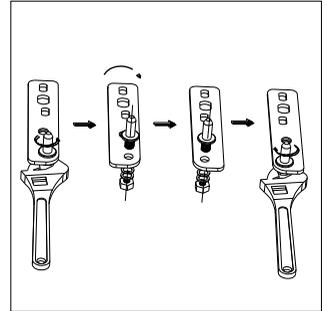
6. Befestigen Sie die Halterung, indem Sie den Stift des unteren Scharniers installieren. Installieren Sie die beiden Nivellierfüße.
