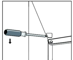
4. Setzen Sie die Kernabdeckung von links nach rechts um. Heben Sie die Tür nach oben heraus und stellen Sie sie auf einer weichen Unterlage ab, um sie nicht zu zerkratzen.
