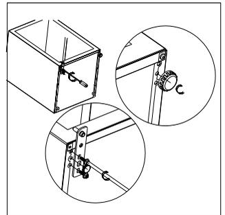
7. Installieren Sie dann wieder die Tür. Vergewissern Sie sich vor dem Festziehen des oberen Scharniers, dass die Tür horizontal und vertikal so ausgerichtet ist, dass die Dichtungen an allen Seiten gut verschlossen sind.
