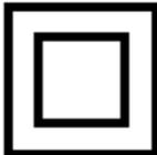
Elektrogeräte mit Schutzklasse II haben eine verstärkte oder doppelte Isolierung in Höhe der Bemessungsisolationsspannung zwischen aktiven und berührbaren Teilen (VDE 0100 Teil 410, 412.1). Sie haben meist keinen Anschluss an den Schutzleiter. Selbst wenn sie elektrisch leitende Oberflächen haben, so sind diese durch eine verstärkte oder doppelte Isolierung vor Kontakt mit anderen spannungsführenden Teilen geschützt
