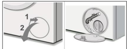
4. Lassen Sie das restliche Wasser mit dem ausziehbaren Ablaufschlauch in der Pumpenöffnung in einen geeigneten Behälter ab (es können bis zu 20 Liter Wasser abgelassen werden). Ziehen Sie die Verschlusskappe vom Schlauch ab, legen Sie den Schlauch über den Behälterrand und lassen Sie das Wasser aus der Trommel vollständig ablaufen. Wenn der Vorgang beendet ist, setzen Sie die Verschlusskappe wieder auf das Ende des Schlauchs und bringen Sie den Schlauch zurück an seinem Aufbewahrungsort an.
