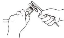
3. Schrauben Sie nun den Wasserzulaufschlauch auf der Rückseite des Geräts mit der Hand ab. Ziehen Sie den Siebfilter mit einer Zange aus dem Wasserzulaufventil an der Geräterückseite heraus und reinigen Sie ihn vorsichtig.
